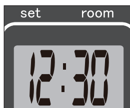
F: Når informationsdisplayet stopper med at blinke, er indstillingen låst til den indstillede værdi.
