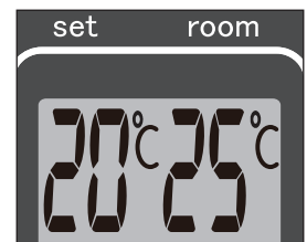
G: Vaadittu lämpötila vasemmalla, mitattu lämpötila oikealla.
