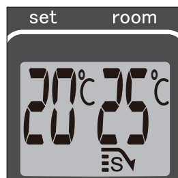
J: När SAVE-lampan tänds stängs värmaren av eller slås på automatiskt för att hålla sig inom ett specificerat temperaturintervall.
