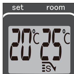
J: Wenn die Kontroll-Lampe SAVE aufleuchtet, schaltet sich der Heizofen automatisch an und aus, um innerhalb eines bestimmten Temperaturbereiches zu bleiben.
