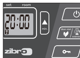
I: Als het 14-teken verschijnt op het display, is het kinderslot ingeschakeld.
