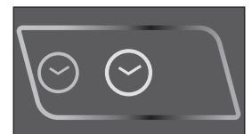
H: TIMER-merkkivalo ilmoittaa, että ajastintoiminto on kytketty pois päältä.
