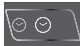
H: TIMER-indikatorlampan indikerar att timerfunktionen är aktiverad.
