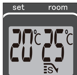
J: Se la spia luminosa SAVE si accende, la stufa si accende e si spegne automaticamente, per rimanere entro una determinata temperatura.
