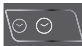
H: Kontrollampen TIMER angiver, at TIMER funktionen er aktiveret.
