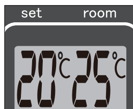
G: Ønsket temperatur til venstre, faktisk temperatur til høyre.
