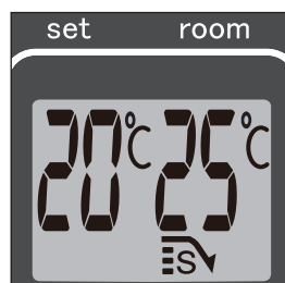
J: Als het lampje SAVE oplicht, slaat de kachel automatisch aan en uit, om binnen een bepaald temperatuurbereik te blijven.
