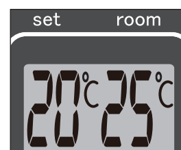
G: A la izquierda la temperatura deseada, a la derecha la temperatura existente
