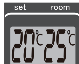
G: Links die eingestellte Temperatur, rechts die tatsächliche Temperatur.
