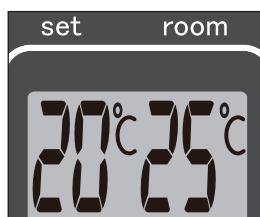
G: Links de gewenste temperatuur, rechts de gemeten temperatuur.
