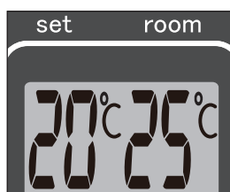
G: Den ønskede temperatur angives til venstre og den aktuelle til højre.
